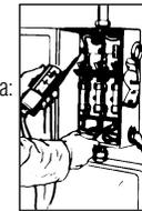
En un circuito trifásico, repita la misma prueba que arriba. Una indicación de falta de voltaje o menor que el voltaje de línea normal indica la presencia de un fusible fundido.
